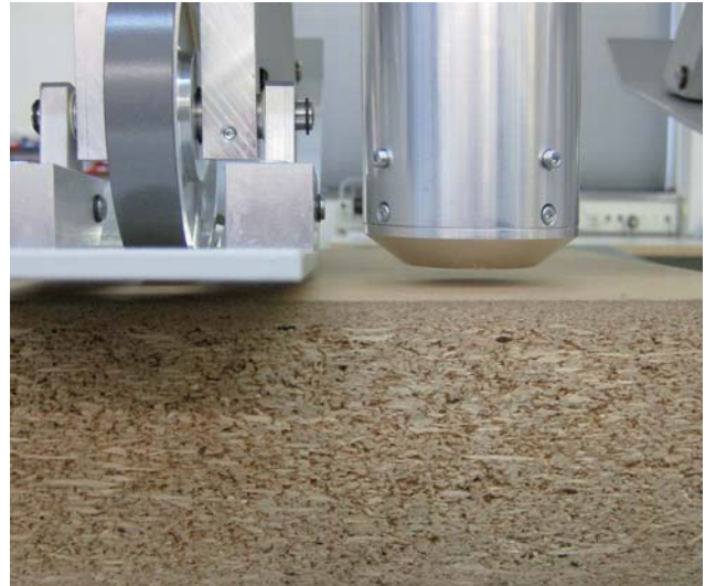
Schallkanal auf Spanplatte (max. 100 mm)
