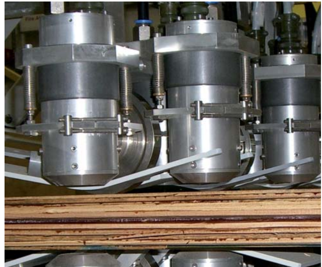
Schallkanäle auf LVL (max. 200 mm)
