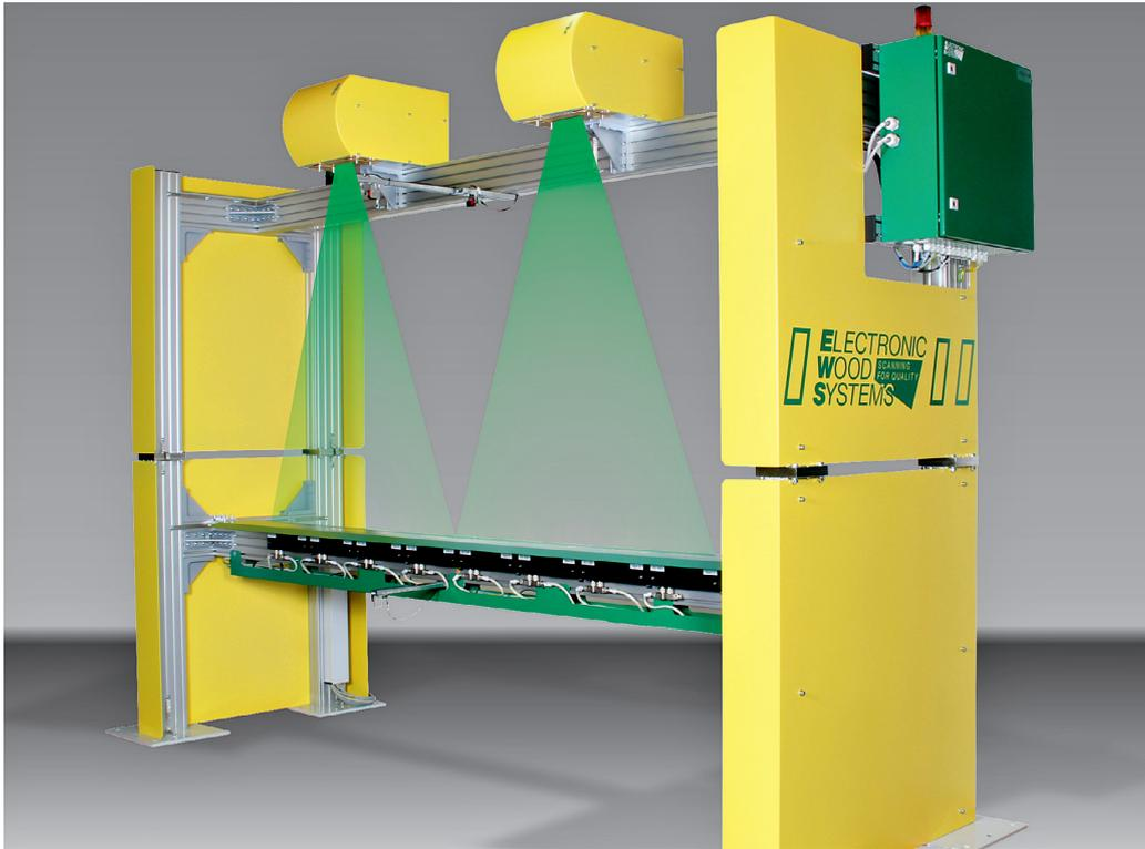
Abb. 8: „Conti-ScaleE X MultiEnergy“: Berührungslose inline Plattenwaage mit Fächerstrahlen. Im Bereich typischer Plattendicken < 40 mm ist der geometrische Messfehler gering. Die „Multi Energy“-Technologie sorgt auch hier für optimale Messwertauflösung zur präzisen Rohdichtemessung (in Kombination mit der Dickenmessung „Thick-Scan“) sogar an leichten Platten
