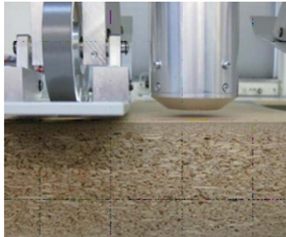
Schallkanäle auf einer dicken Spanplatte
