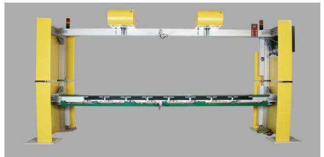
CONTI-SCALE X mit 2 Röntgenstrahlern (oben) und 8 Detektoren (unten)
