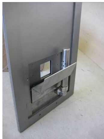
Innenansicht mit Sammelchale und pneumatischem Düsendorn
